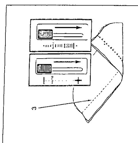
Une tension trop faible produira un point lâche et des boucles dans les coutures (3). Ajustez la tension en déplaçant le levier vers le bas pour un réglage plus serré.
