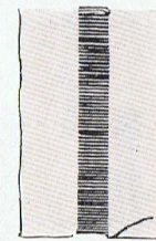
Richtig regulierte Oberfadenspannung
