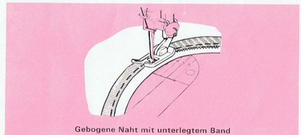
Gebogene Naht mit unterlegtem Band
