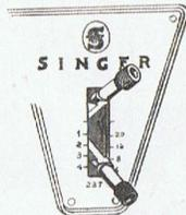
Die Zahlen auf der Skala rechts geben die Anzahl der Stiche pro Zoll an. Die Zahlen auf der Skala links geben die Stichelänge in Millimeter an. Der Bereich oberhalb der Zahlen bis zu der horizontalen Markierungslinie (= absolute Nullstellung) wird für die Einstellung von Zickzack-Raupennähten verwendet. Siehe Seite 32.
