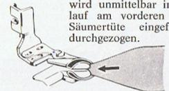
Beim Durchlaufen der Säumertüte werden die Schnittkanten nach innen eingeschlagen.
