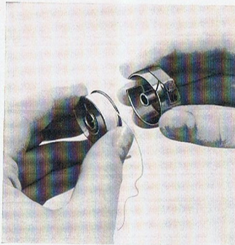
Abb. 3: unter der Feder durch. Wenn Sie am Faden ziehen, muß sich die Spule im Uhrzeigersinn (also in Pfeilrichtung) drehen. Das Fadenende lassen Sie 6—7 cm überstehen.
