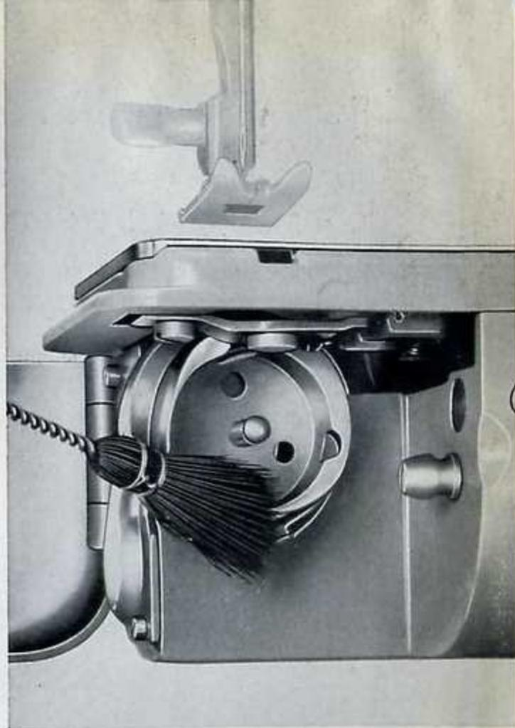
Auch den Greiferraum sollten Sie öfters von abgelagerten Nähstaubteilen befreien. Öffnen Sie hierzu die Armverschlußklappe und entnehmen Sie die Spulenkapsel samt Spule. ▲
