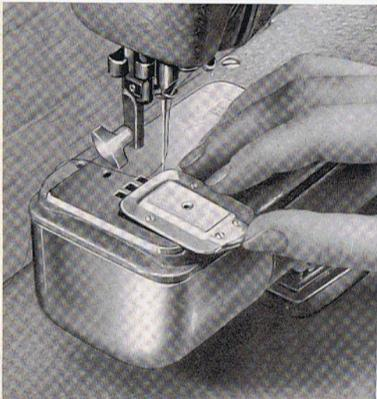
Schrauben Sie den Fuß ab und versenken Sie den Transporteur. Anschließend ist die Überdeck-Stopfplatte Nr. 60407 mit Rundloch aufzusetzen, die die Freihandführung erleichtert und die Spannung des in den Ring eingespannten Stoffes erhöht. Die Stopfplatte ist so von vorn aufzuschieben, daß ihre Federzunge in den Ausschnitt der Stichplattenkante eingreift. Zum Schluß wird die Stopfarbeit in den Stopfring eingespannt.
