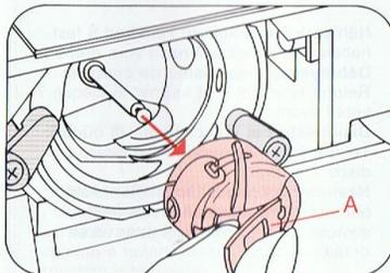
Klappe A anheben und die Spulenkapself herausziehen.
