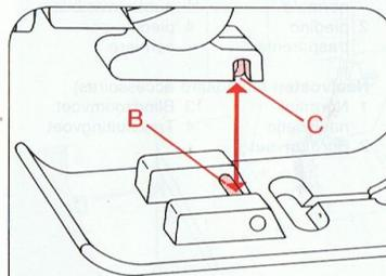
**Nähfuß anbringen:** Stoffdrückerhebel senken und den Fuß dabei so schieben, daß der Steg B in die Nuten C einrastet.
