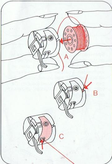
**Spule einlegen A (Faden nach hinten).** Den Faden in den Schlitz B und unter der Feder hindurch in die Öffnung C ziehen.
