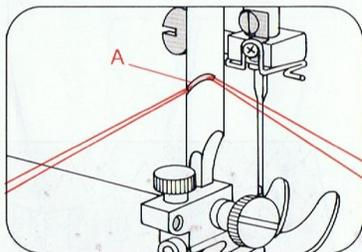
Fadenabschneider A. Fäden einlegen und nach unten ziehen.
