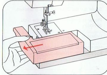
**Spulen vorbereiten:** Unter die Nähfläche 9 greifen und diese nach links herausziehen.
