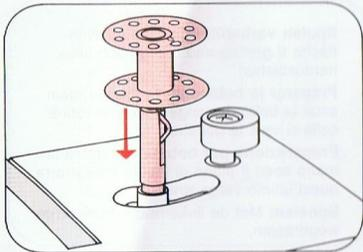
Spule auf die Spulerspindel 5 stecken.
