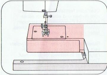
Die Freiarm-Modelle haben einen Freiarm für röhrenförmiges Nähgut.
