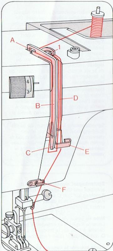
**Oberfaden einlegen:** Nadel und Fadenhebel müssen oben stehen. Nähfuß anheben. Den Faden in die Führung A, den Schlitz B, hinter das Führungsblech C, nach oben in den Schlitz D, in den Fadenhebel 1, zurück durch den Schlitz D, in die Führungen E, F und in die rechte Führung am Nadelhalter ziehen.
