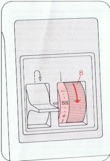
Zum Nähen der **Stretchstiche** (grün) muß der Stichtlängen-Einsteller auf Symbol S. S. gestellt werden. Je nach Stoffart kann der Stretchstich durch Drehen nach + verlängert oder durch Drehen nach - verkürzt werden.
