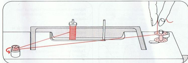
**Spulen:** Den Faden von der Garnrolle in die Spulervorspannung 2 ziehen, zur Spule führen, durch ein Loch der Spule fädeln und festhalten. Den Fußanlasser betätigen und aufspulen. Dabei den Faden nach einigen Umdrehungen loslassen. Die volle Spule nach links drücken, abnehmen und den Faden abschneiden.
