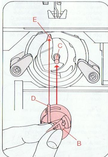
**Spulenkapsel einsetzen:** Klappe B anheben und die Kapsel bis zum Anschlag auf Stift C schieben. Der Kapselfinger D muß dabei in den Ausschnitt E eingreifen.
