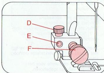
D und E sind zum Lineal befestigen. F ist die Nähfußhalterschraube.
