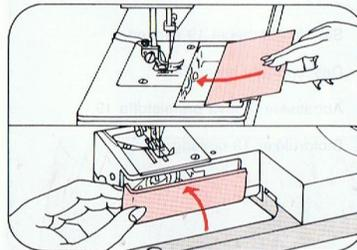
Grundplattendeckel 25 einsetzen, oder Verschlussklappe 10 schließen.
