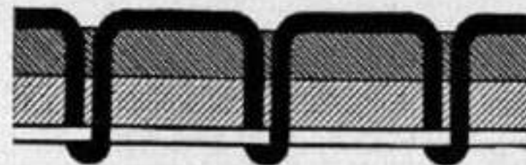
Oberfadenspannung zu schwach oder Unterfadenspannung zu stark
