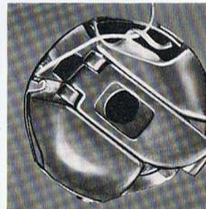
Den Faden zusätzlich unter das gebogene Häkchen der Spulenkapsel, wie auf dem Foto dargestellt, durchführen und 10 cm heraushängen lassen. Nun Klappe an der Spulenkapsel öffnen und diese auf den Greiferdorn schieben. Beim Loslassen der Klappe ist die Spulenkapsel eingerastet.
