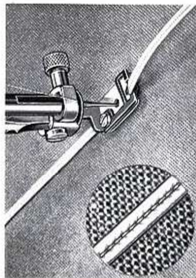
40 93 005. Nähfuß zum Aufnähen von Litzenband. Das Band durch eine Führung ziehen und mit einer geraden Naht mitten auf dem Band festnähen.
