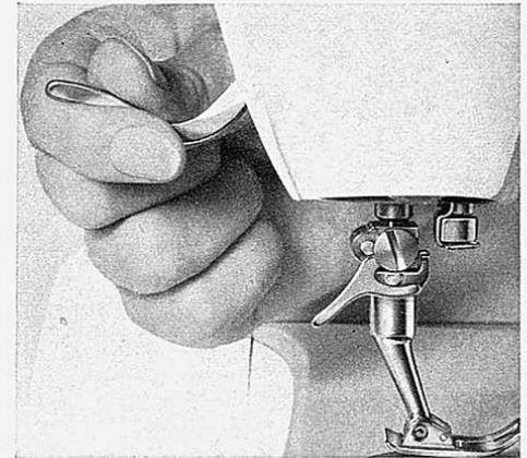
Befestigungshebel lösen und Nähfuß ab-
