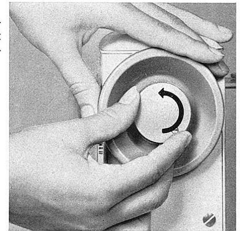
Klappe am Ständerdeckel heben. Darunter befindet sich die Spulereinrichtung.
