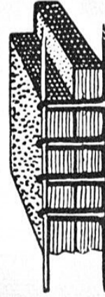
Abb. b Der Oberfaden ist zu stark, oder der Unterfaden zu schwach gespannt. Die Verknüpfung ist oben am Stoff sichtbar.
