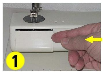
Zum herausnehmen der Spulenkapsel muss zuerst mit dem Handrad die Nadel auf höchste Position gebracht werden.
