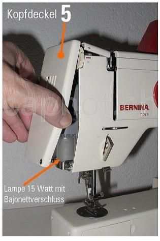
Mit dem Kippschalter (6) am Kopfdeckel wird das Nählicht ein- und aus geschaltet. Die 15 watt Glülampe hat Bajonettverschluss.
