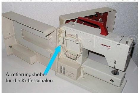
Nach dem wir den Knopf 27 gelöst haben werden beide Kofferteile nach hinten geklappt. (Bild 6.1)
