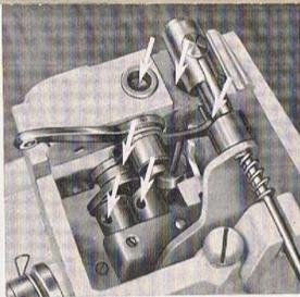
ölen Sie bitte nichts, denn die Sinterlager der ADLERETTE brauchen keine Wartung und Schmierung. Hat die Maschine lange Zeit unbenutzt gestanden, bringen Sie etwas Petroleum an alle beweglichen Teile und lassen die Maschine mit angehobenem Fußchen laufen. Dann Schmutz abwischen und nachölen. Benutzen Sie nur gutes harz- und säurefreies Nähmaschinenöl.
