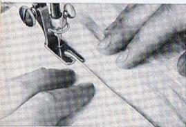
Stofflagen aufgesteppt wird. Dann wird der Stoff auseinandergelegt und die hochstehende Kante in den Kapper eingelegt und niedergenäht. Dabei die beiden Stoffteile leicht glattziehen.
